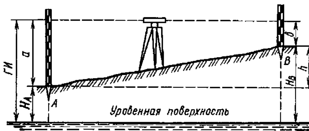
Рисунок 9.1 – Схема геометрического нивелирования
