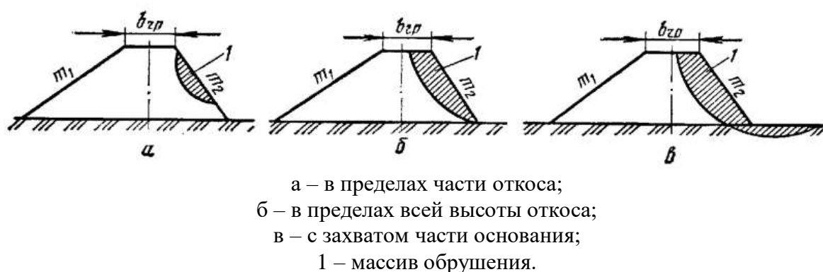
Рисунок 9.1 – Виды оползания откосов
