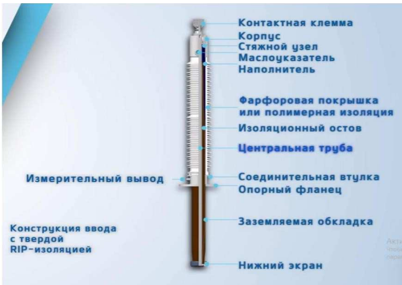
Рисунок И.1 – Конструкция ввода с твердой RIP-изоляцией
