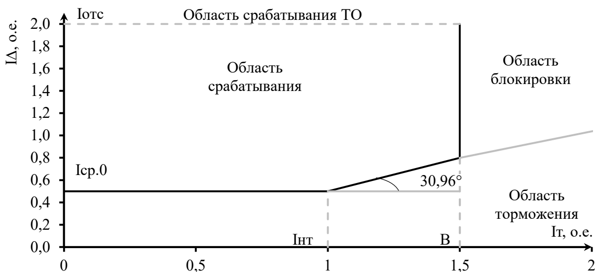
Рисунок 5.2 – Характеристика срабатывания дифференциальной защиты генератора
