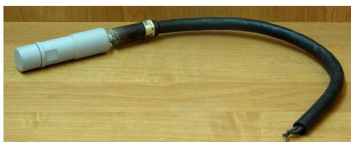
Рисунок 9.8 – Преобразователь давления измерительный струнный
