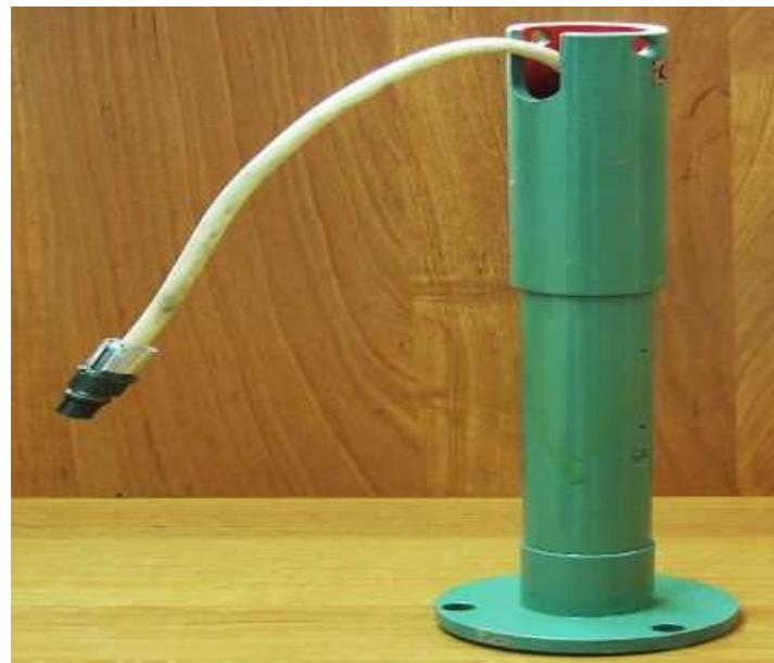
Рисунок 9.6 - Преобразователь линейных перемещений измерительный струнный
