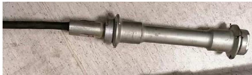
Рисунок 9.1 – Тензометр ТБ-200
