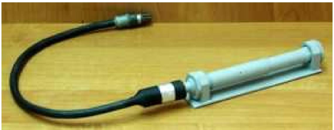
Рисунок 9.7 – Преобразователь линейных деформаций измерительный струнный
