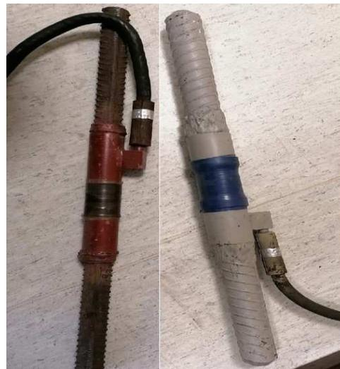
Рисунок 9.9 – Преобразователи силы арматурные измерительные струнные
