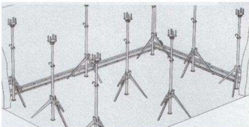
Рисунок 5.4 - Общий вид помещения после монтажа основных стоек
