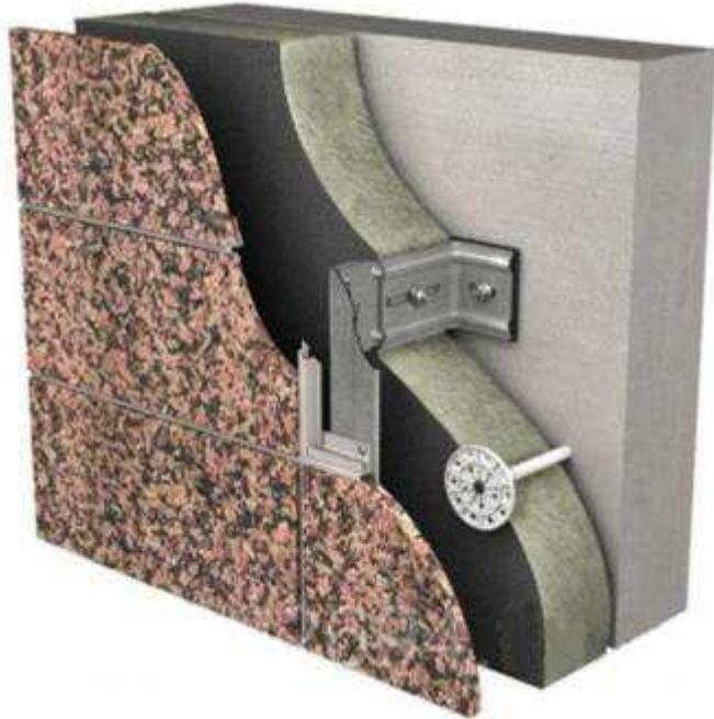
Рисунок 3. Пример навесной фасадной системы
