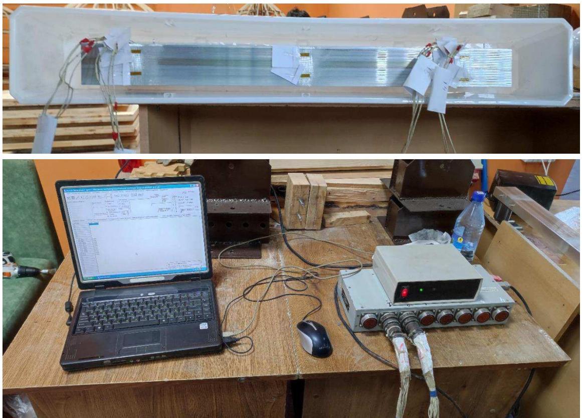
Рисунок 56- Подключенная многоканальная микропроцессорная тензометрическая система ММТС-64.01
