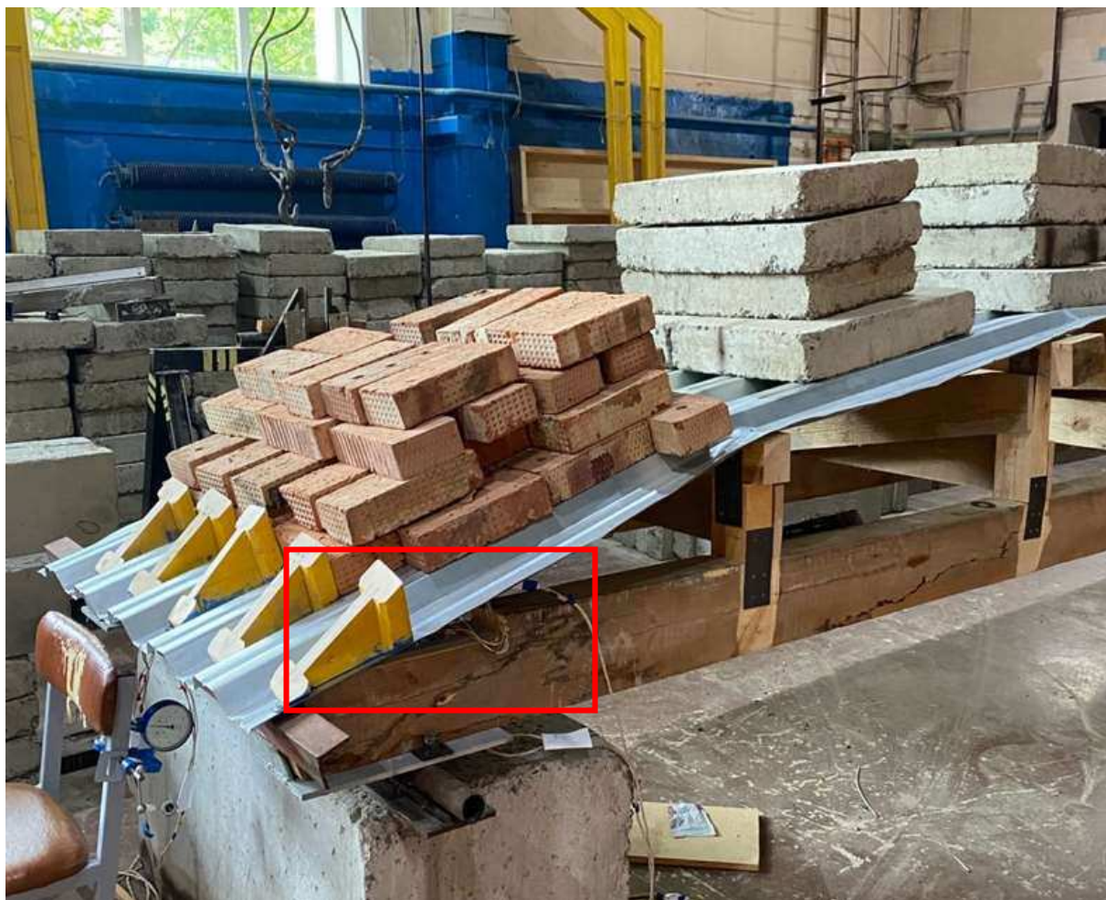
Рисунок 4.18 – Деформации возникшие в профилированном листе;
