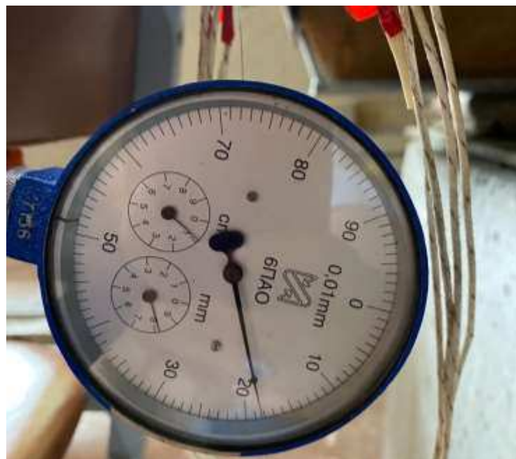
Рисунок 4.8 – Показание прогибомера перед началом испытания;
