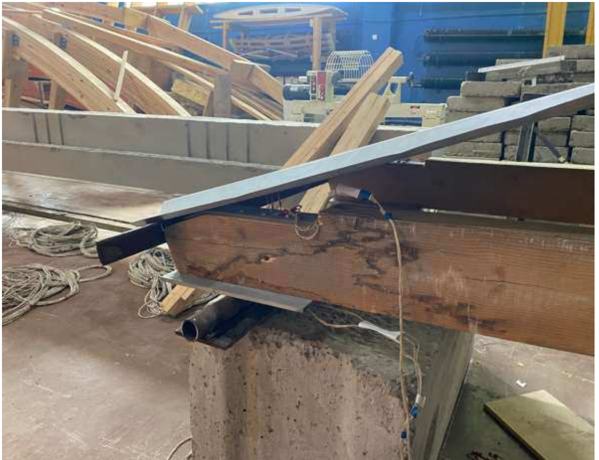
Рисунок 4.7 – Модель блок-свода с подключенными тензорезисторами;
