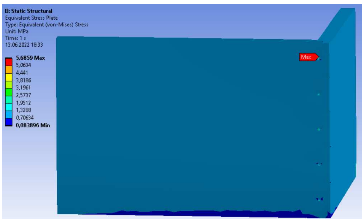
Рисунок 4.4.9 – Напряжения в стеновых панелях Мизес Ansys max 5,6859МПа
