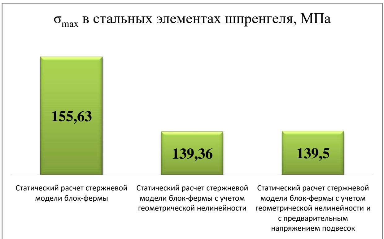
Рисунок 4.19 – Сравнение результатов напряжений в стальных элементах статического расчета модели блок-фермы с различными условиями, МПа
