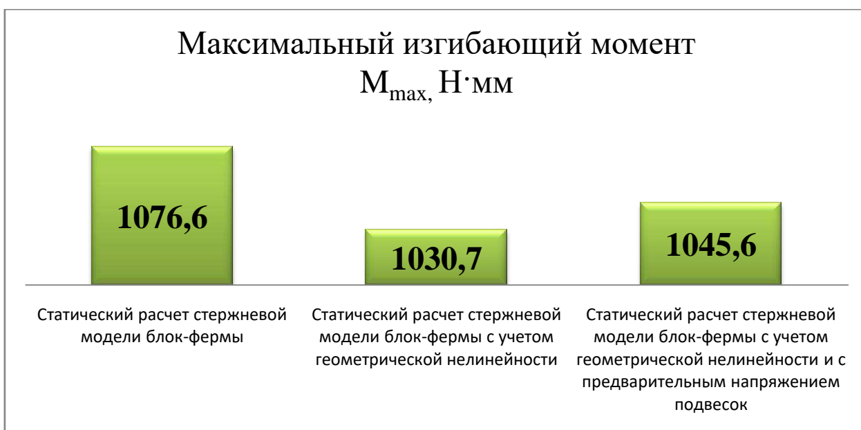
Рисунок 4.20– Сравнение значений изгибающего момента при статическом расчете модели блок-фермы с различными условиями, МПа
