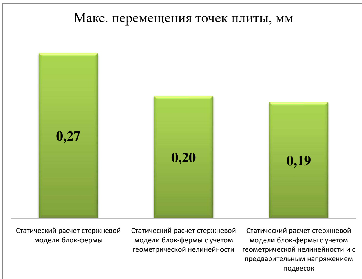
Рисунок 4.17 – Сравнение результатов макс. перемещений плиты статического расчета модели блок-фермы с различными условиями, мм
