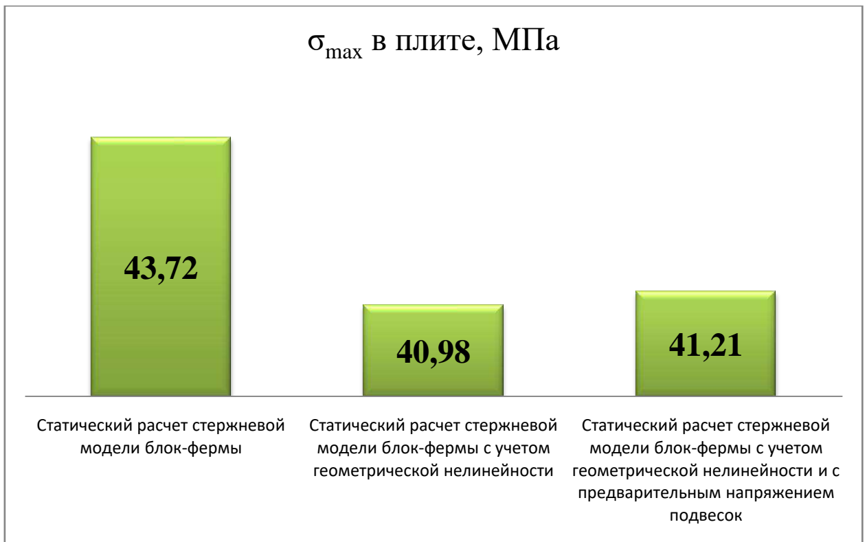
Рисунок 4.18 – Сравнение результатов напряжений в плите статического расчета модели блок-фермы с различными условиями, МПа
