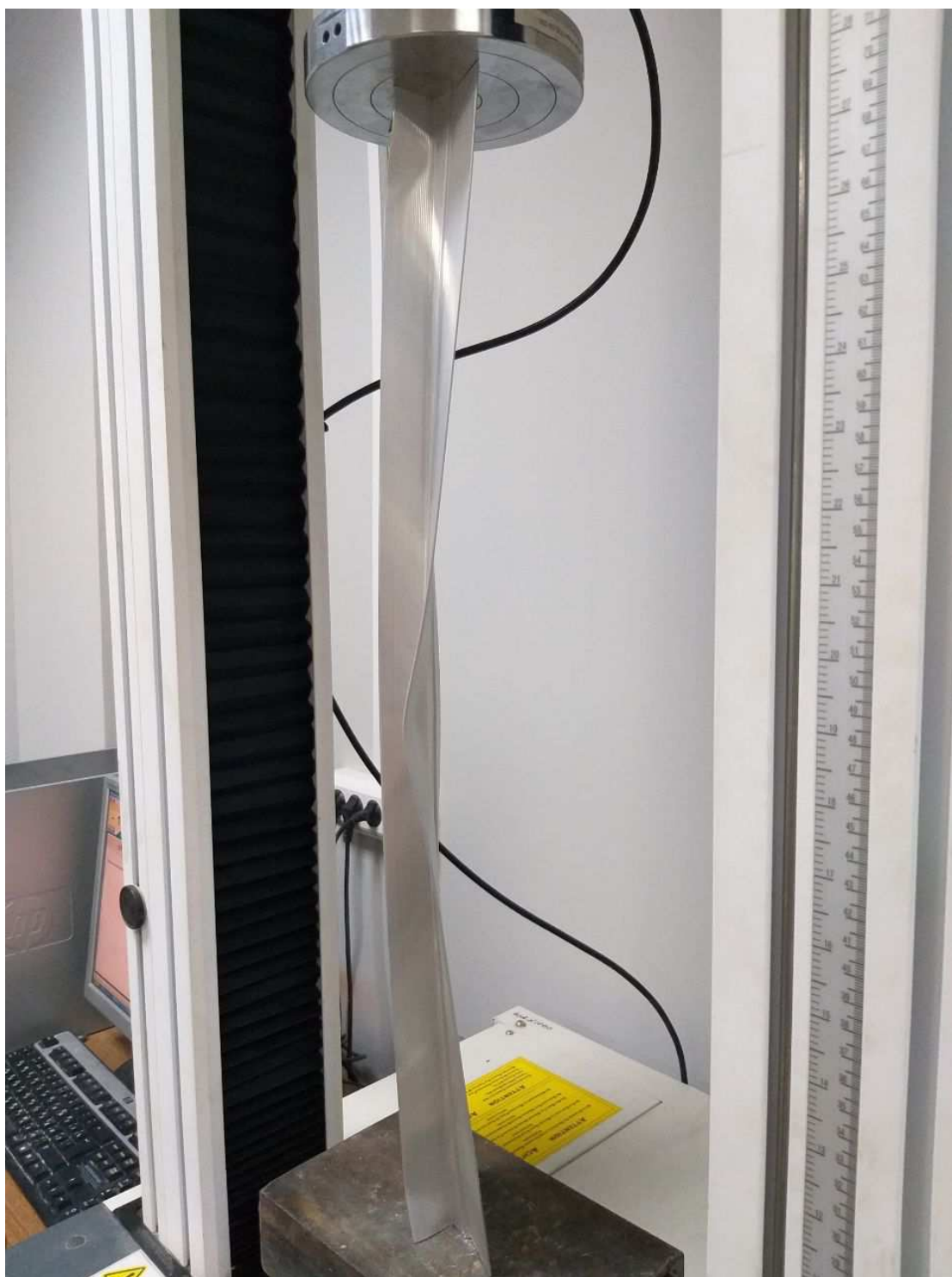
Рисунок 3 3 - Фиксация потери общей и местной устойчивости профиля НК 04А
