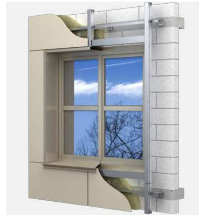
Система крепления в межэтажные перекрытия
