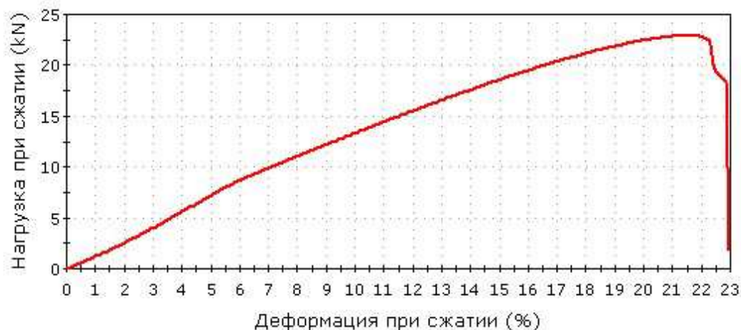
Рисунок 3.4 - График зависимости нагрузки при сжатии (кН) и деформации при сжатии (%) профиля НК 04А
