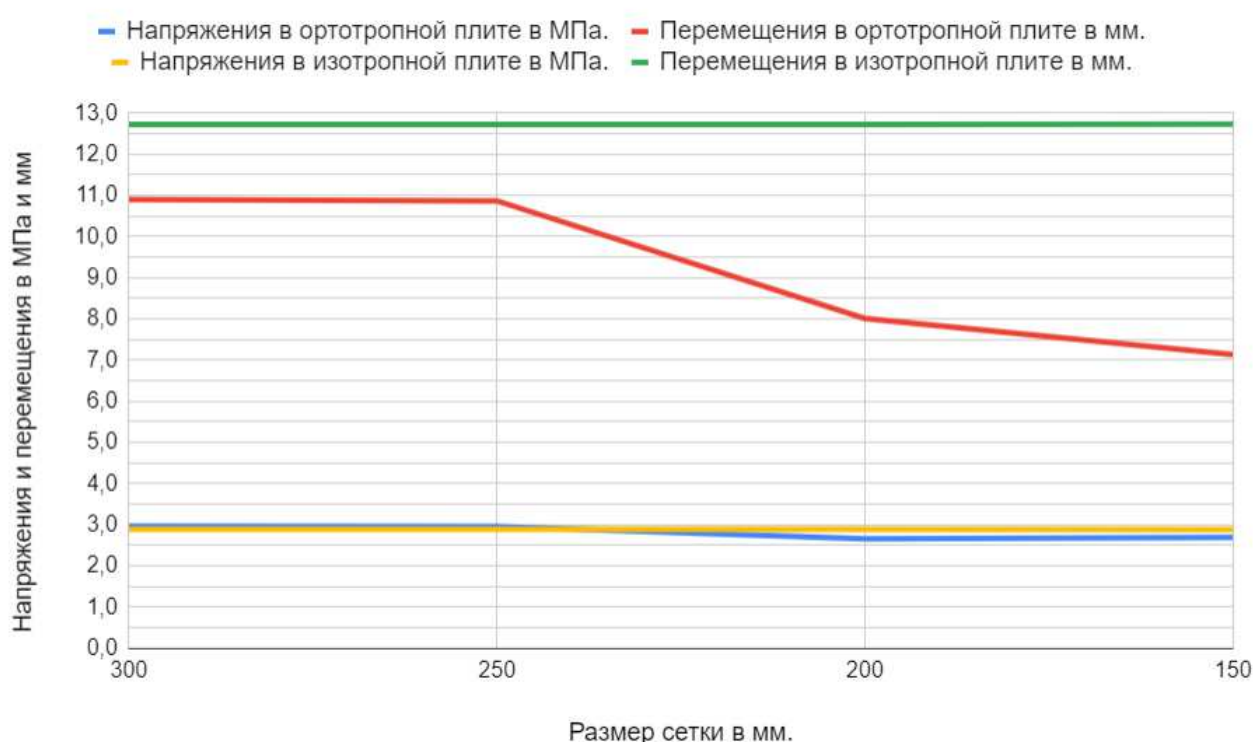
Рисунок 2.26 – График сравнения зависимостей ортотропного материала и изотропного.
