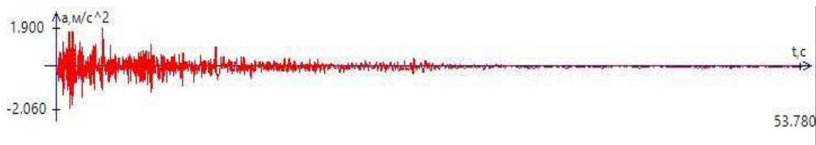
Рисунок 3.92 – Вертикальная составляющая акселерограммы землетрясения Эль-Сентро
