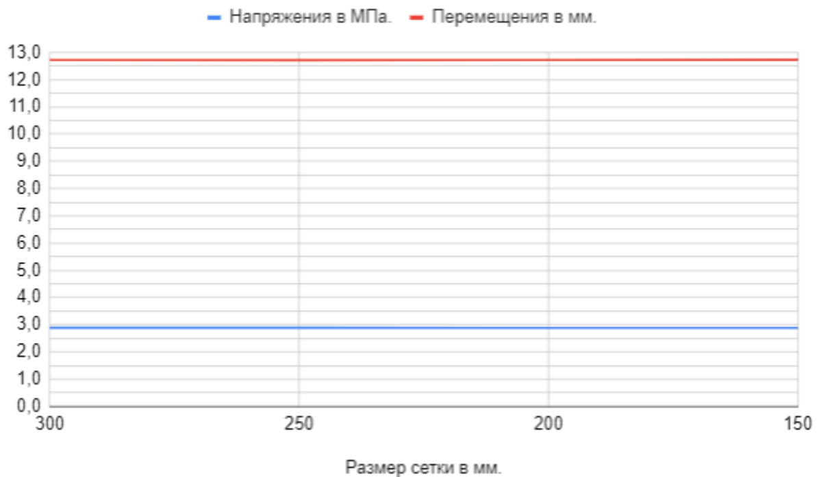
Рисунок 2.25 – График зависимости напряжений и перемещений от размера сетки в ортотропной модели материала
