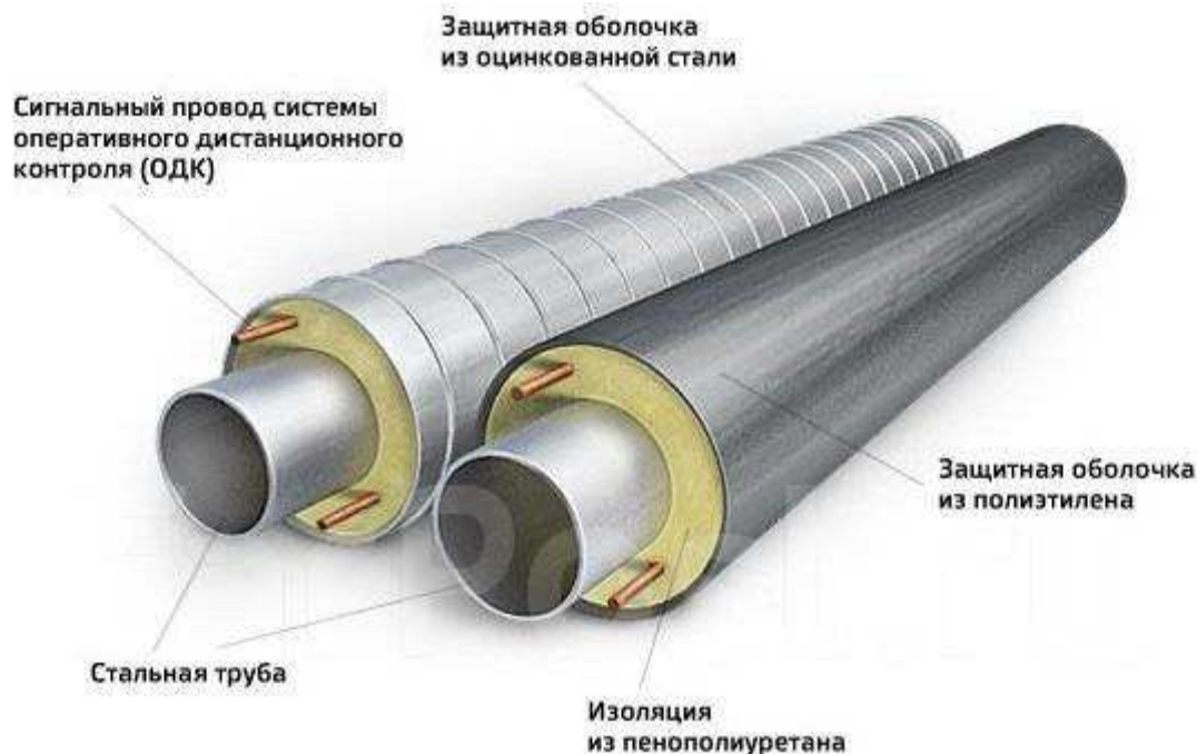
Рисунок 10 - Конструкция стального трубопровода с ППУ-изоляцией.
