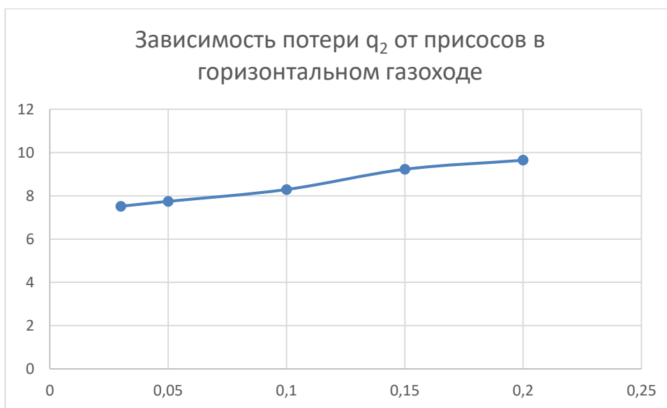
Рисунок 21-Зависимость потери q_2 от присосов в горизонтальном газоходе
