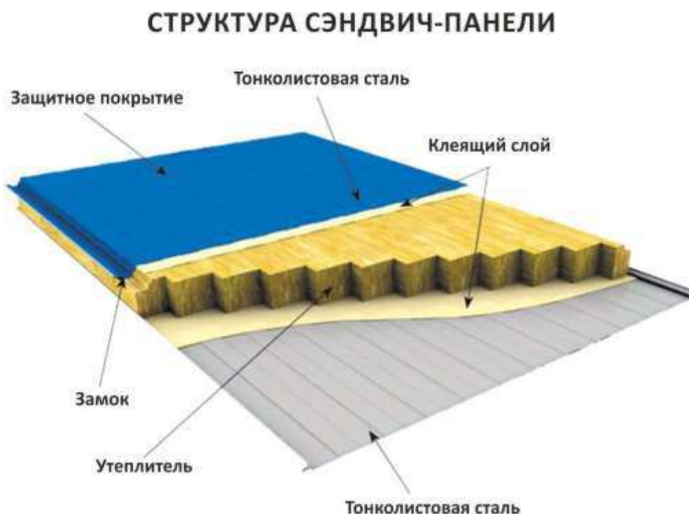
Рисунок 2 – Состав панели типа «сэндвич»
