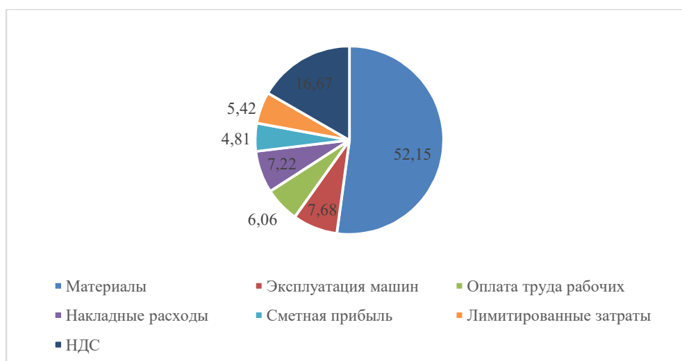
Рисунок 6.3 – Структура локального сметного расчета на устройство металлического каркаса по составным элементам, %
