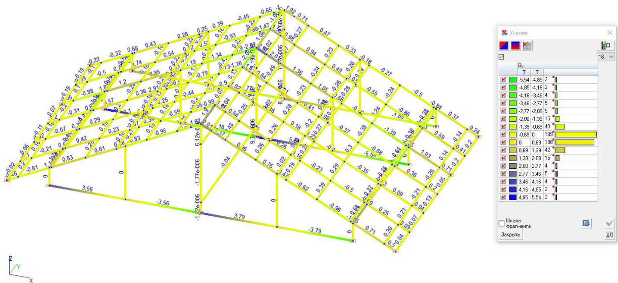
Рисунок 2.16 – Эпюра поперечной силы Q_z от комбинации нагрузок №2, т
