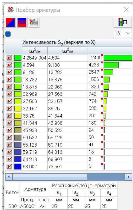
Рисунок 3.24 – Изополя армирования плиты интенсивность S_2 (верхняя по X)
