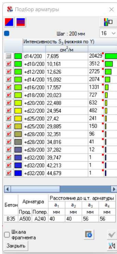
Рисунок 3.37 – Изополя армирования плиты интенсивность S_3 (нижняя по Y)
