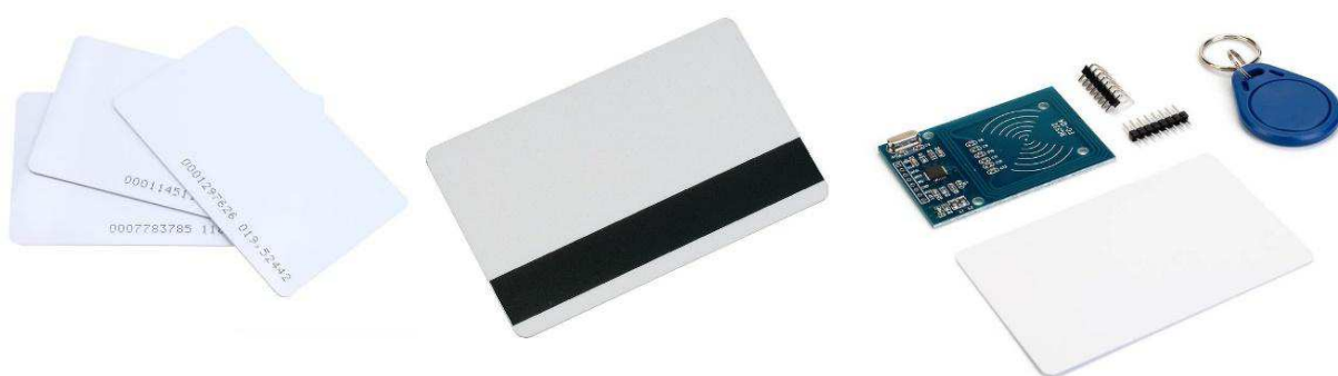
Рисунок 3 – Идентификаторы proximity-card, магнитная карта, карта с RFID-меткой
