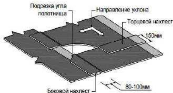
Рисунок 5.3 – Нахлесты полотнищ рулонного материала
