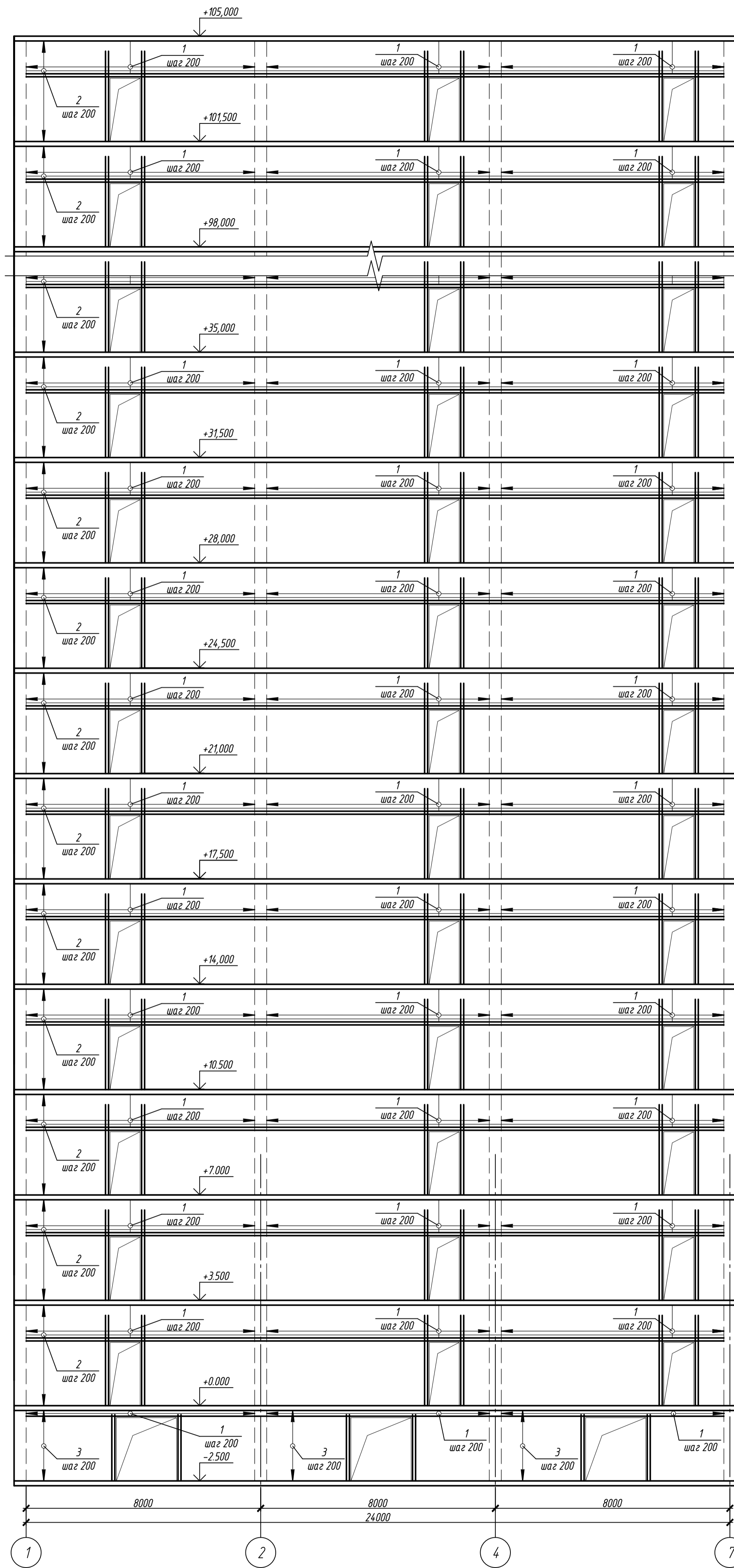
Армирование стены СТ1 по оси Б
