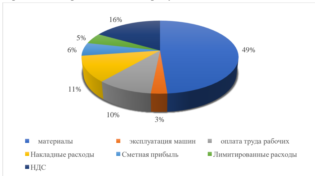
Рисунок 7.6 – Структура локального сметного расчета на устройство кровли
