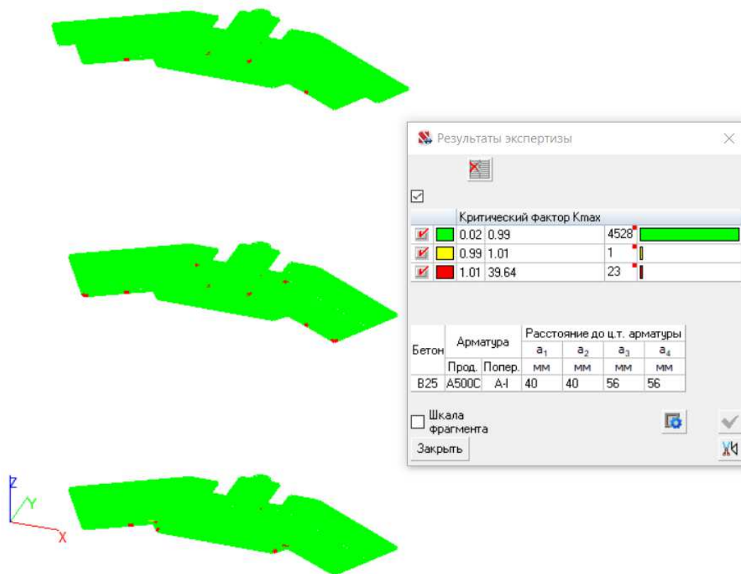
Рисунок 3.42 – Результаты экспертизы плит перекрытия
