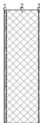
Рисунок 1.2 – Конструктивная схема ограждения стены 1 – фанера, 2 – утеплитель Rockwool «СЭНДВИЧ БАТТС ЭКСТРА», 3 – фанера
