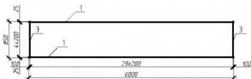
Рисунок 3.3 – Арматурные сетки фундамента
