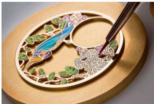
Рисунок 30 – Покрытие броши горячей эмалью
