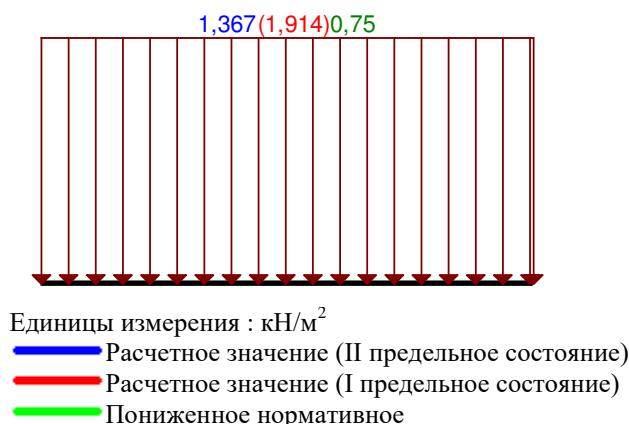
Рисунок 2.1 – Нормативное и расчетное значение снеговой нагрузки, кН/м<sup>2</sup>.
