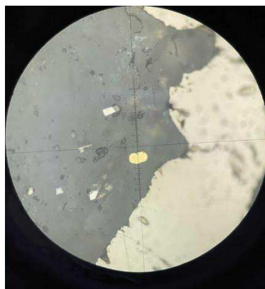
Рисунок 15 – Самородное золото (жёлтое) в нерудной массе (серое). Николи ||. Ув. 20 x . Ширина поля зрения 1,8 мм.
