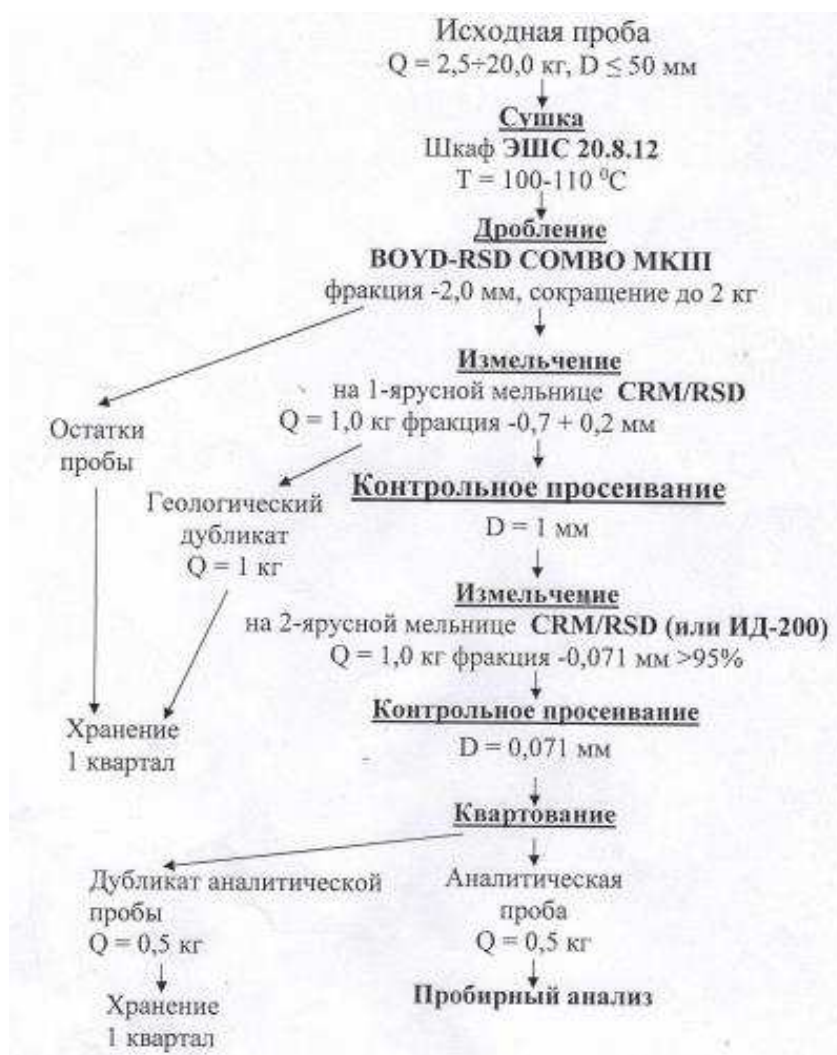
Рисунок 20 – схема пробоподготовки для пробирного анализа
