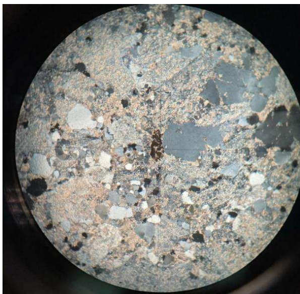
Рисунок 17 – Кварц (серое) в мусковит-серицитовой массе. Ник. «||». Ув. 40 x .
