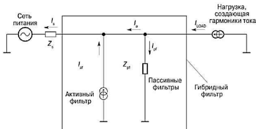
Рисунок 14 – Структурная схема гибридного фильтра с параллельным включением пассивного и активного фильтра. [60]
