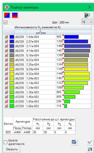
Рисунок 2.8 – Нижняя арматура вдоль цифровых осей
