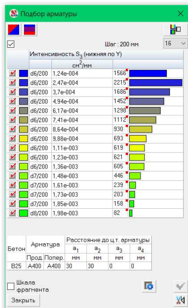
Рисунок 2.7 – Нижняя арматура вдоль буквенных осей
