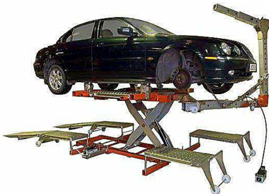
Рисунок 3.4 – Пример станда для восстановления геометрических размеров кузова или рамы - стапель Autorobot XLS++
