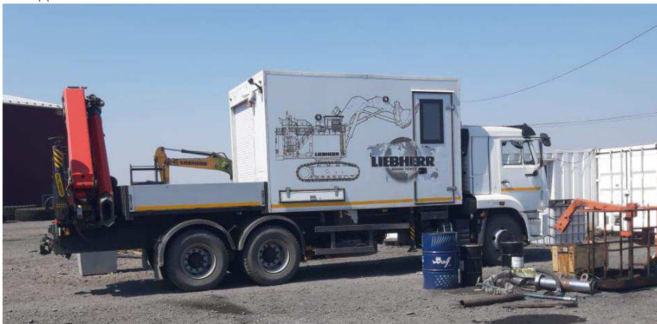
Рисунок 1.5 - Специализированная машина для производства ТО и ТР.
