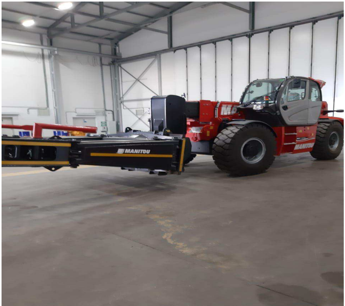
Рисунок 1.8 - Универсальный колёса съёмник «MANITOU»
