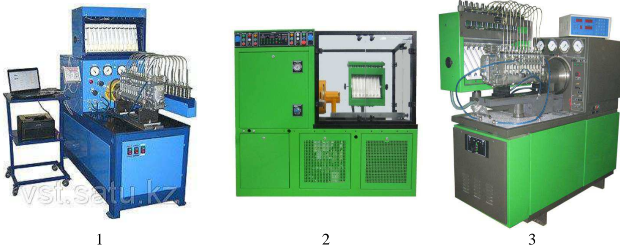
1 – Стенд для испытания ТНВД СДМ-12-11; 2 – Стенд для диагностики насосов высокого давления ТНВД 18-45 kw усиленный; 3 – Стенд для испытания и регулировки ТНВД 12PSDB - 15 кВт. Рисунок 3.1 – Стенды для испытания и регулировки ТНВД
