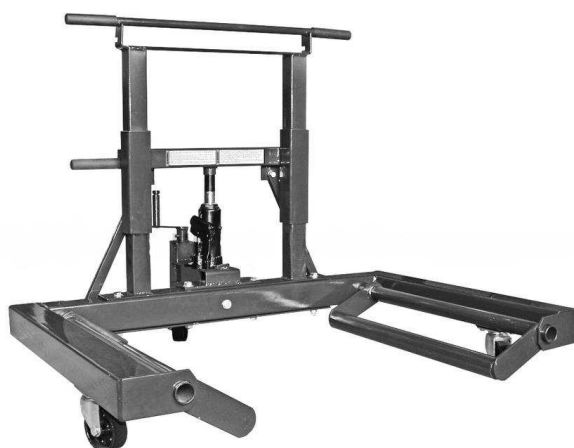
Рисунок 3.1 - Профессиональная тележка Гараж Тулз г/п 0,7 тонны для снятия и установки колес грузовых автомобилей и спецтранспорта. На направляющих три вращающихся колеса, цена – 18712 руб.
