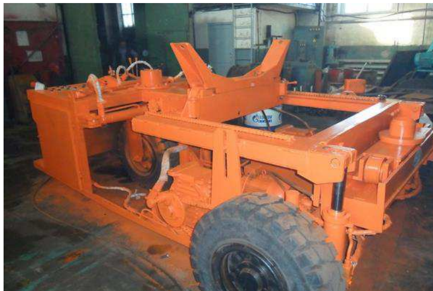
Рисунок 3.6 – Устройство гидромеханическое г/п 13тонн для снятия и установки мотор-колес и агрегатов а/м БелАЗ-7512, 7513 (на дизельном двигателе) 31-54
