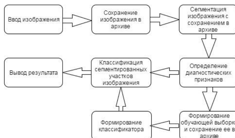
Рисунок 1.4 – Структурная схема системы автоматизированного распознавания изображений световой микроскопии
