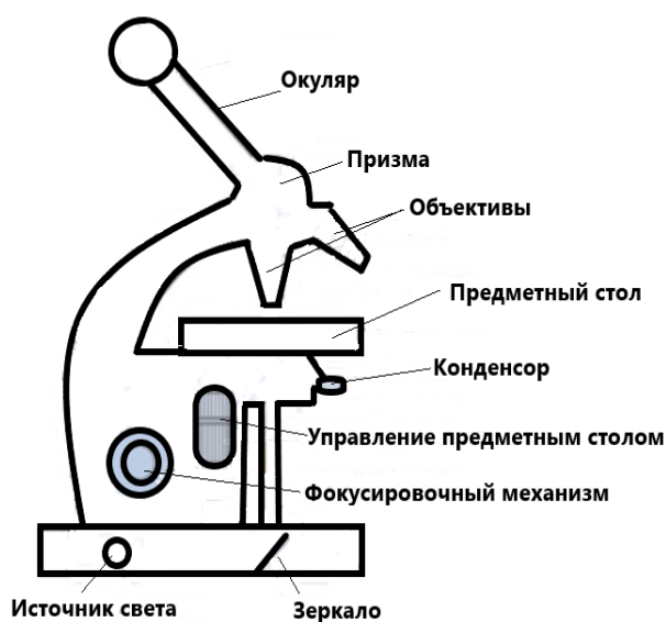
Рисунок 1.1 – Структура светового микроскопа
