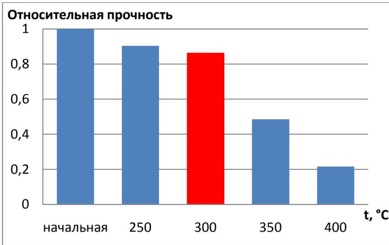
Рисунок 2 – Относительные значения прочности образцов в зависимости от температуры обработки
