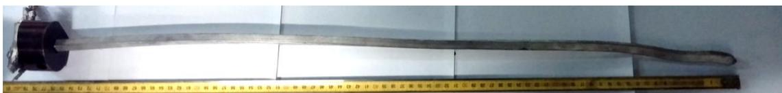
Рисунок 14 – Типичный вид образца алюминиевого полуфабриката после Мульти-РКУП-К
