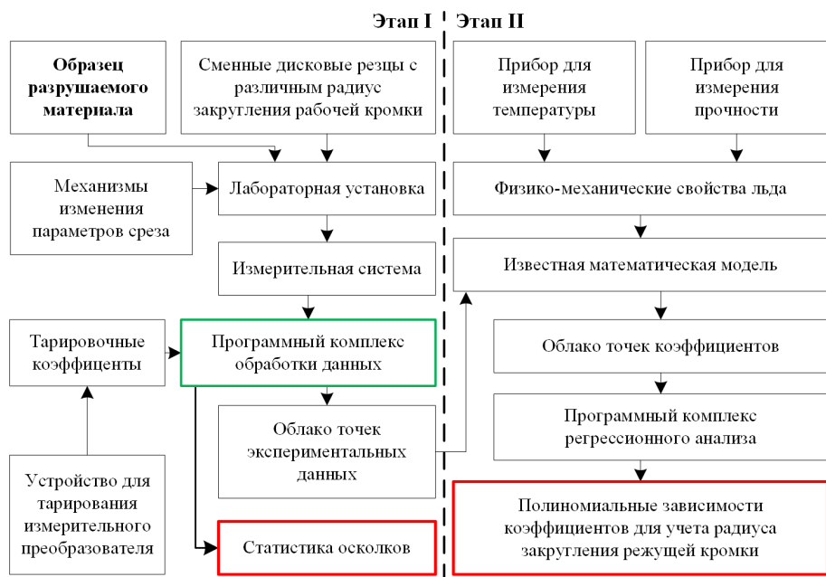
Рисунок 1 — Структурная схема метода контроля силы сопротивления прочных снежно-ледяных образований резанию дисковым инструментом
