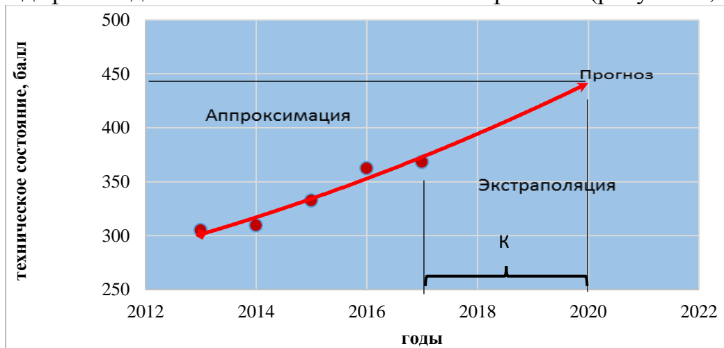
Рисунок 9 – Прогноз динамики изменения объём дефектов (ТС) тоннеля «Истиклол» на 2018-2021 гг.
