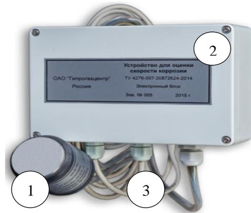
1 – датчик; 2 – электронный блок; 3 – соединительные кабели
