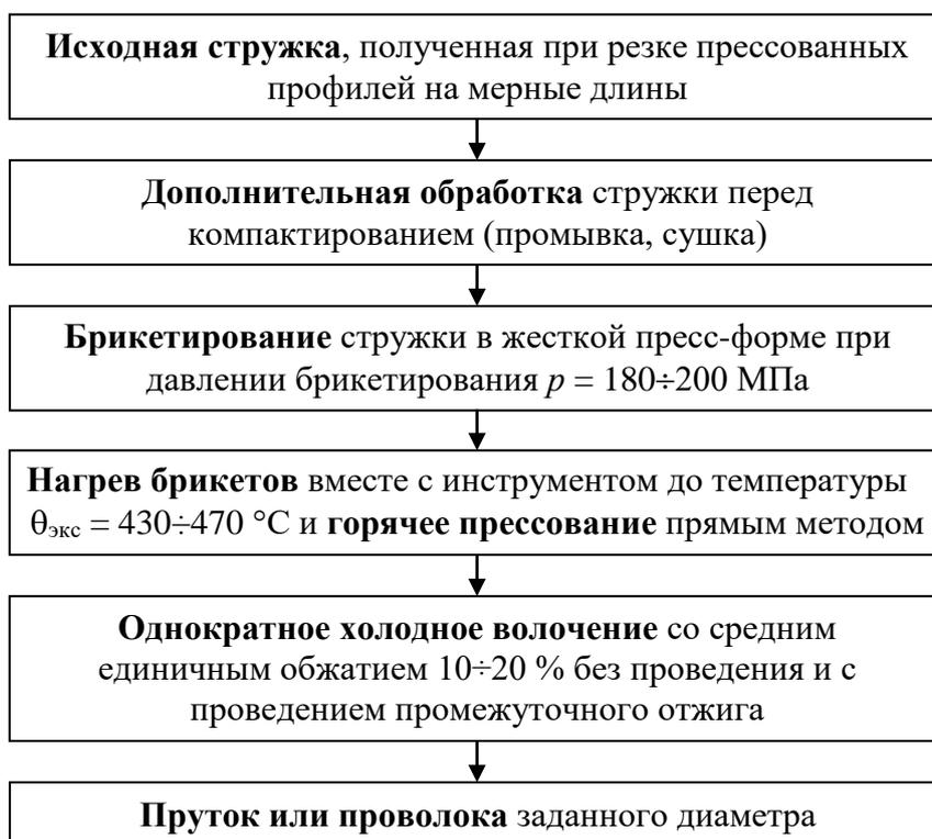
Рисунок 1 – Технологическая схема получения деформированных полуфабрикатов с помощью метода дискретного прессования
