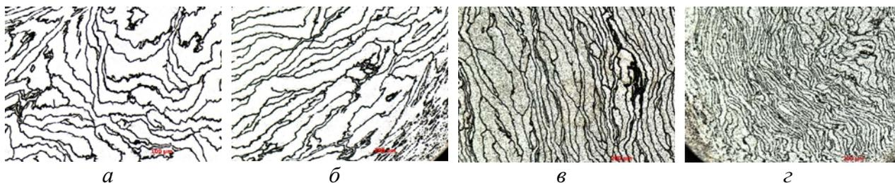
Рисунок 16 – Микроструктура поперечного сечения проволоки из сплава АД31 диаметрами 5,0 (а) 3,7 (б), 2,8 (в) и 1 мм (г), полученной из прутка диаметром 6 мм, ( $\times 160$ )
