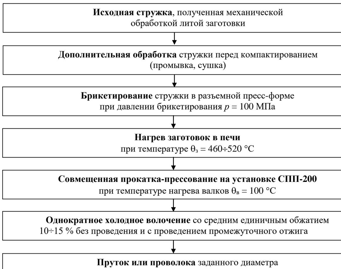
Рисунок б – Технологическая схема получения деформированных полуфабрикатов из стружки алюминиевых сплавов с помощью метода совмещенной прокатки-прессования
