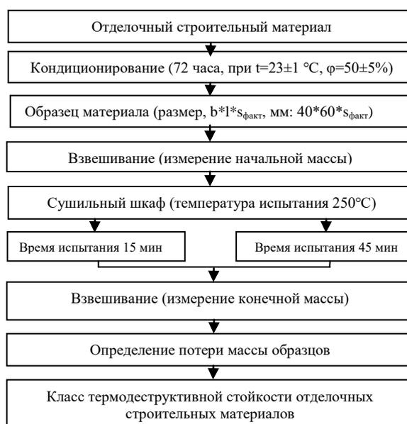
Рисунок 5 – Метод контроля термодеструктивной стойкости отделочных строительных материалов
