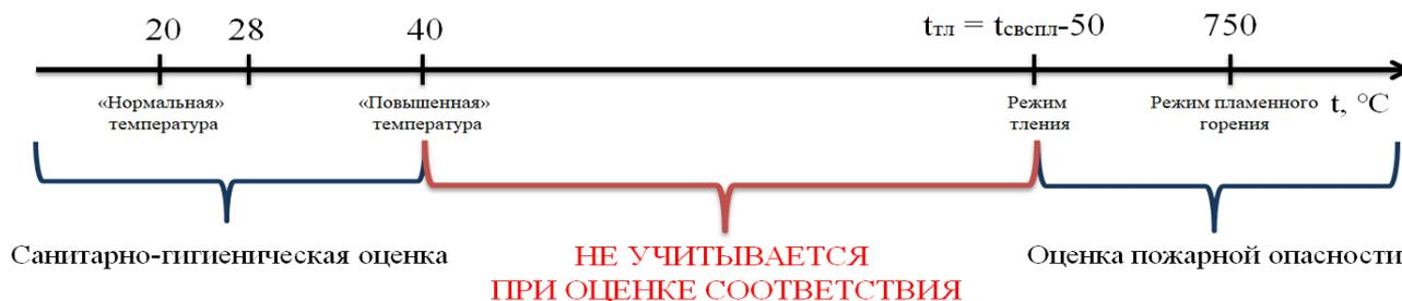
Рисунок 1 – Температурные режимы оценки соответствия отделочных строительных материалов требованиям безопасности
