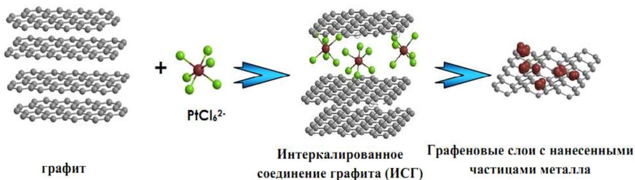
Рисунок 1.13 - Схема интеркалирования графита платиной [66]
