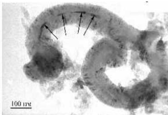
Рисунок 1.14 - Микроструктура УНТ, легированных частицами меди [85]
