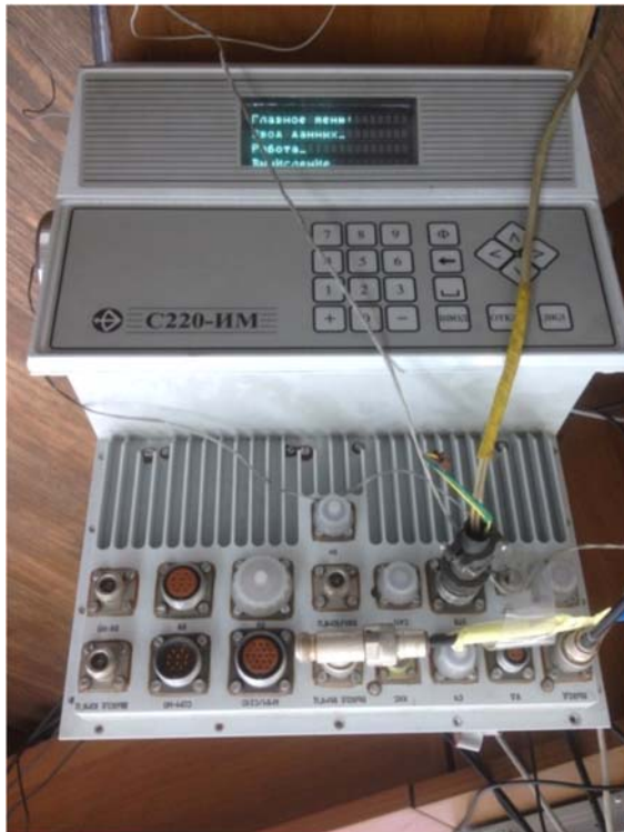
Рисунок 4.14 – Экспериментальная модель: а – имитатор сигналов опорных станций, б – плата демодулятора
