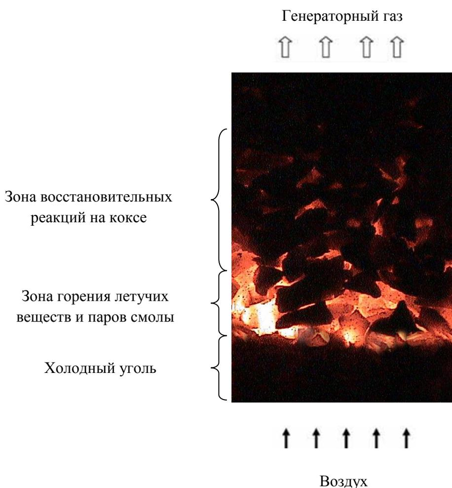
Рисунок 3.1 – Фотография волны физико-химических превращений при слоевой газификации угля с обращенным дутьем
