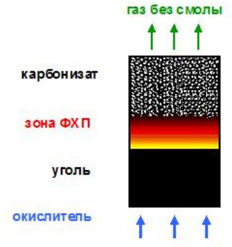
Рисунок 1.18 – Принципиальная схема процесса ТЕРМОКОКС-С [5]
