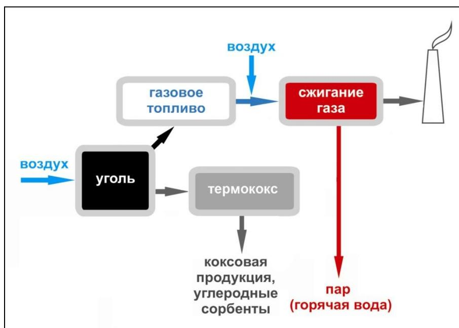
Рисунок 1.13 – Принципиальная схема энерготехнологической концепции ТЕРМОКОКС [5]
