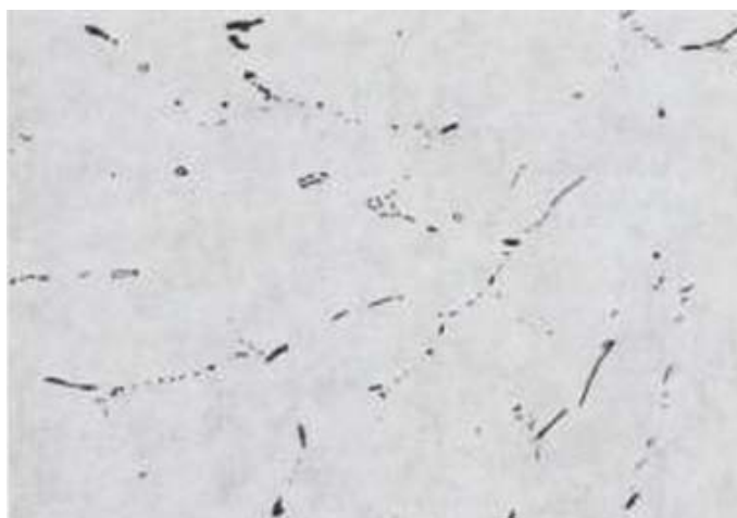
Рисунок 3.8 – Структура гомогенизированного слитка из сплава 1100 (20%-ный раствор серной кислоты, 455x) [61]
