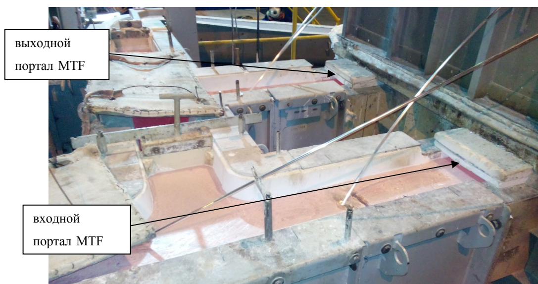
Рисунок 4.1 – Непрерывная подача лигатурного прутка в металлотракт до входного портала и после выходного портала МТФ при непрерывной разливке слитка
