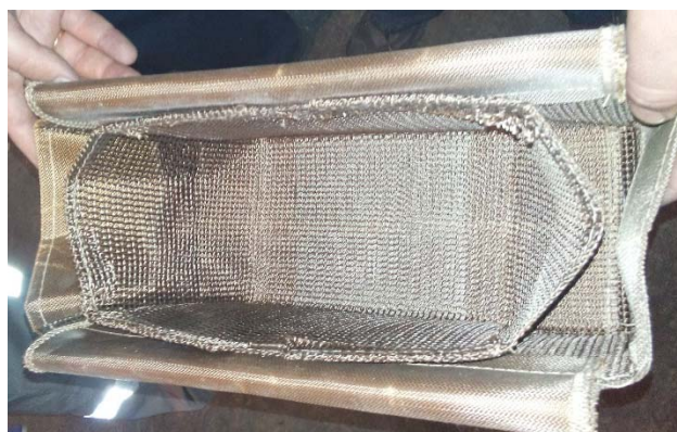
Рисунок 3.13 - Термоформованные распределители металла (Combo-bag): новый – а, после литья – б
