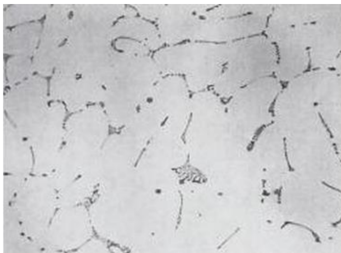
Рисунок 3.7 – Литейная структура сплава 1100 (0,5 %-ный раствор плавиковой кислоты, 455x) [61]
