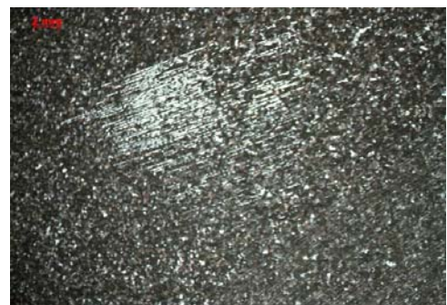
Рисунок 4.4 – Верхняя структура: а – модифицирование лигатурой AlTi5B0,2 до SNIF; б, в – после SNIF
