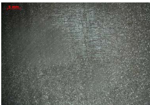
Рисунок 4.4 – Верхняя структура: а – модифицирование лигатурой AlTi5B0,2 до SNIF; б, в – после SNIF
