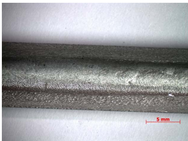
Рисунок Б5 – Внешний вид прутковой лигатуры AlTi5B1, а – маркировка лигатуры; б, в – поверхность лигатуры
