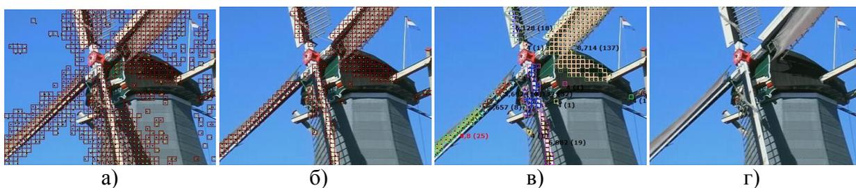
Рисунок 38. Этапы выделения дыма – видеопоследовательность «Видео без дыма 5». Кадр 1. Параметры алгоритма:  $Blk=8$ ,  $T=20$ ,  $Rate=1$ : (а) – все движение в кадре, (б) – серое движение в кадре, (в) – расчет турбулентности, (г) – результат работы алгоритма
