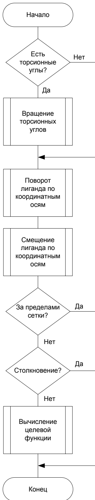
Рисунок 3.8 - Блок-схема алгоритма вычисления целевой функции
