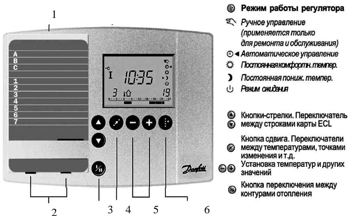
Рисунок 1.12 – Общий вид электронного регулятора: 1 – чип-карта ECL; 2 – индикатор контура; 3 – селектор контура; 4 – смена дисплея; 5 – настройка; 6 – режим контроллера
