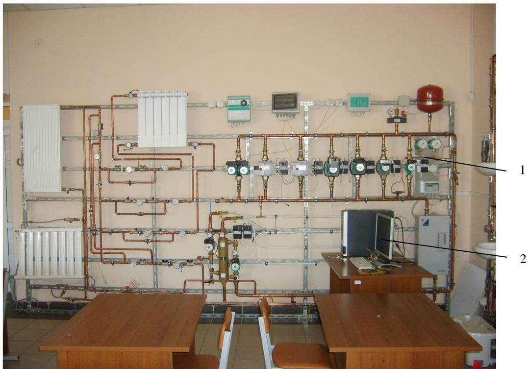
Рисунок 3.1 – Общий вид стенда «Отопление»: 1 – стендовое оборудование; 2 – компьютерная система измерений
