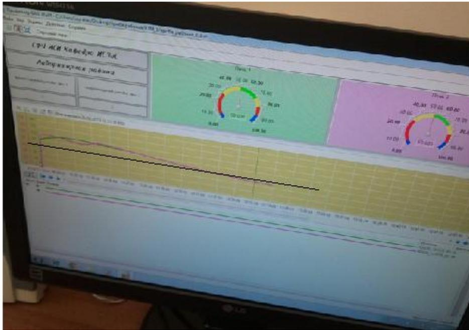
Рисунок 3.31 – Процесс нагрева теплоносителя, измеренный измерителем-регулятором ТРМ151
