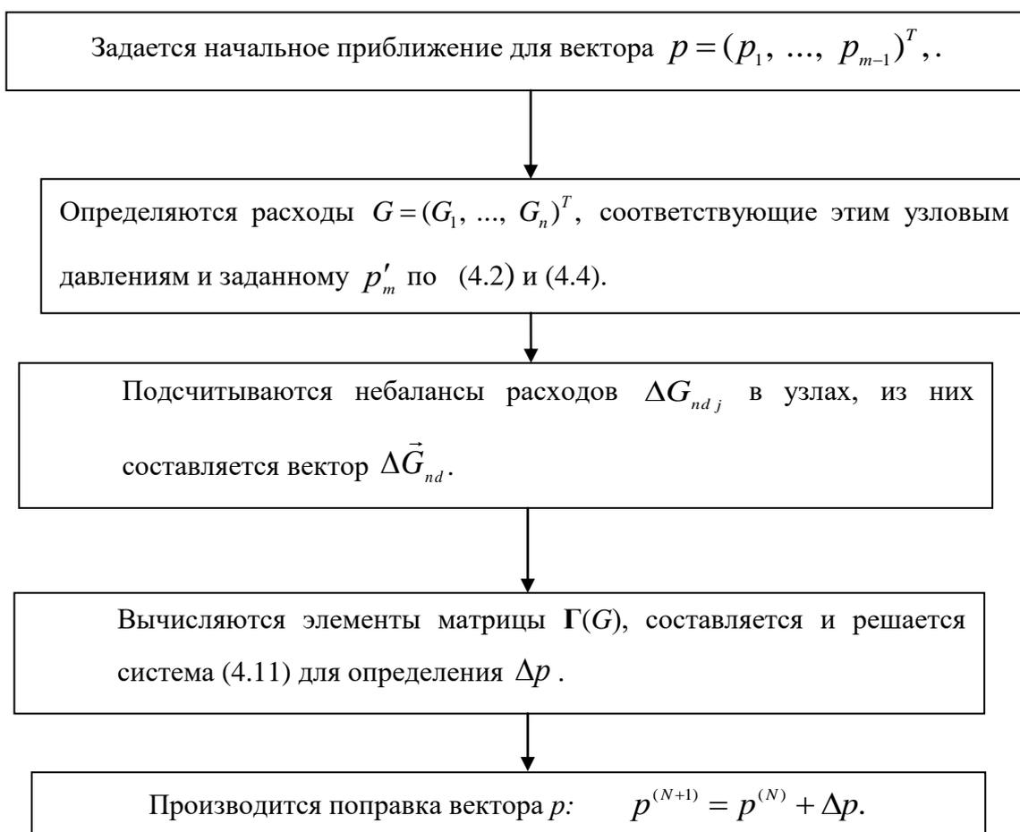
Рисунок 4.4 – Алгоритм обобщенного метода узловых давлений
