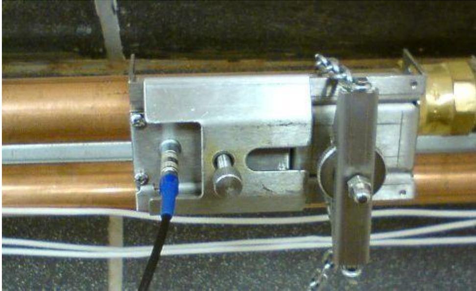
Рисунок 3.8 – Накладные ультразвуковые датчики
