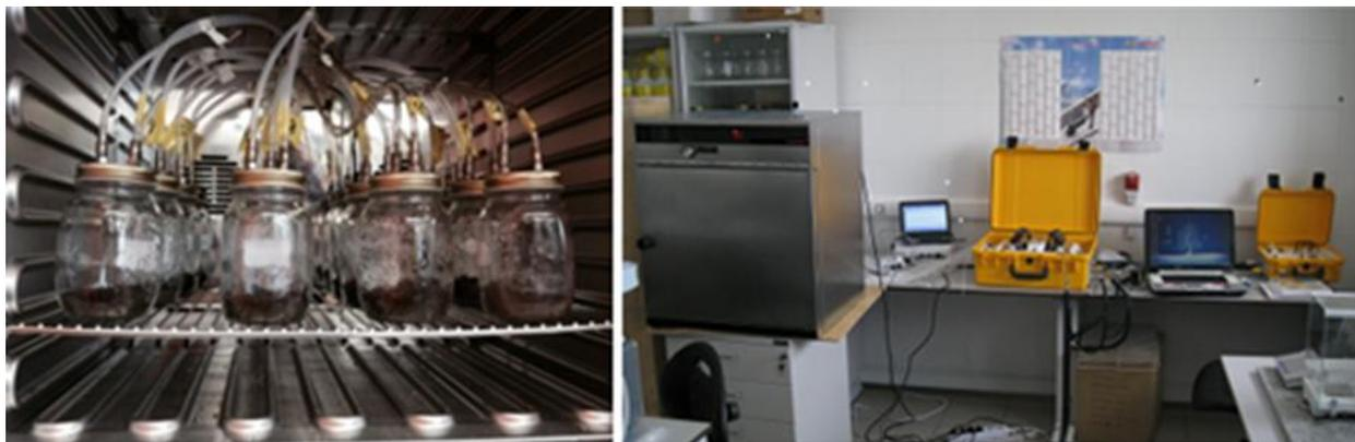
**Рисунок 2.6. Инкубационный шкаф (Memmert IPP500) и 16-канальный мультиплексер (Li-Cor 8150), соединенный с инфракрасным анализатором (Li-Cor 8100).**
