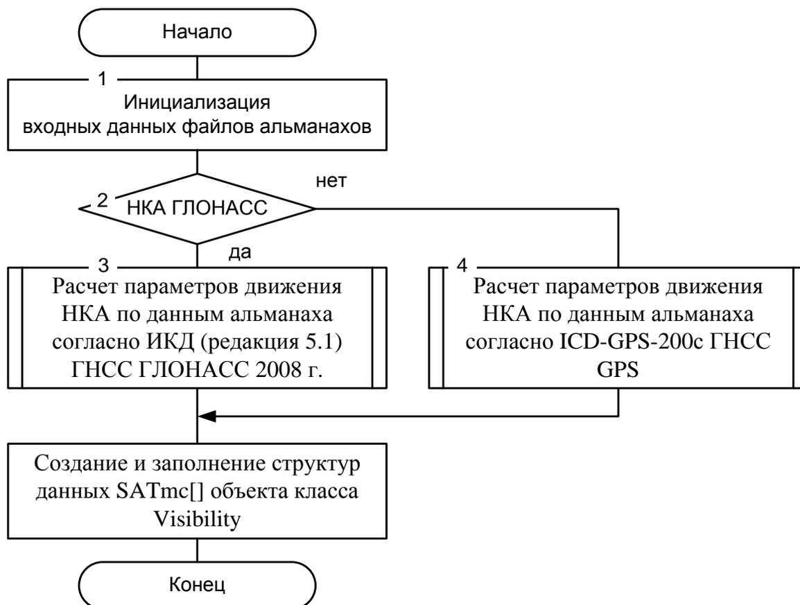
Рисунок 4.6– Блок схема модуля определения координат навигационных КА ГЛОНАСС и GPS по данным альманаха.
