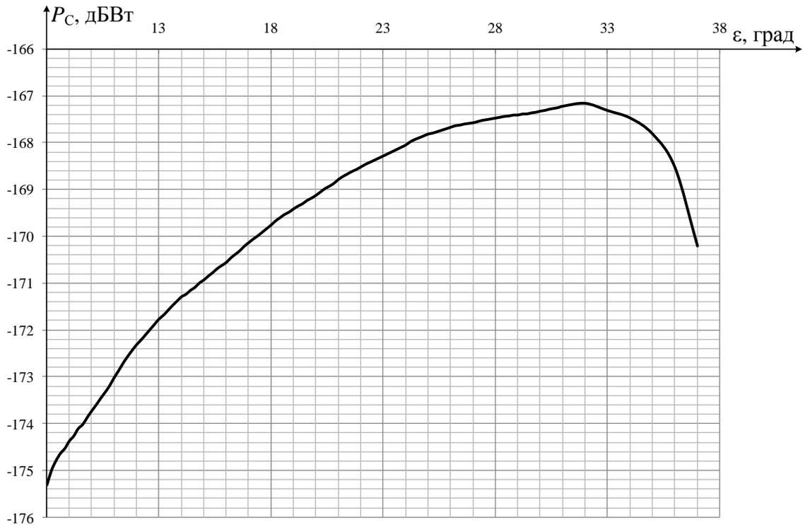
Рисунок 2.13 – Зависимость мощности принимаемого сигнала МРЛ НКА
