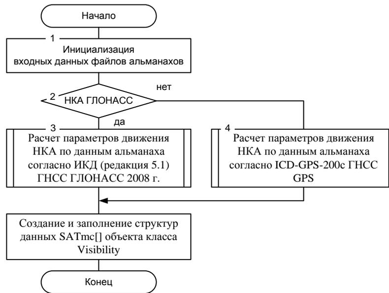
Рисунок 4.8 – Блок схема модуля расчета местоположения НКА
