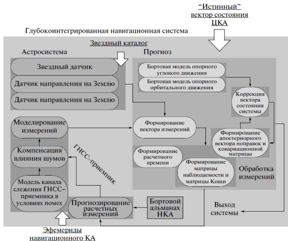
Рисунок 1.4 – Архитектура глубокоинтегрированной АСН
