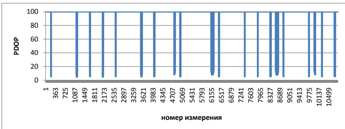
Рисунок 4.31 – Геометрический фактор в СРНС ГЛОНАСС, в режиме: тип спутника ГЛОНАСС-К, частота L1.
