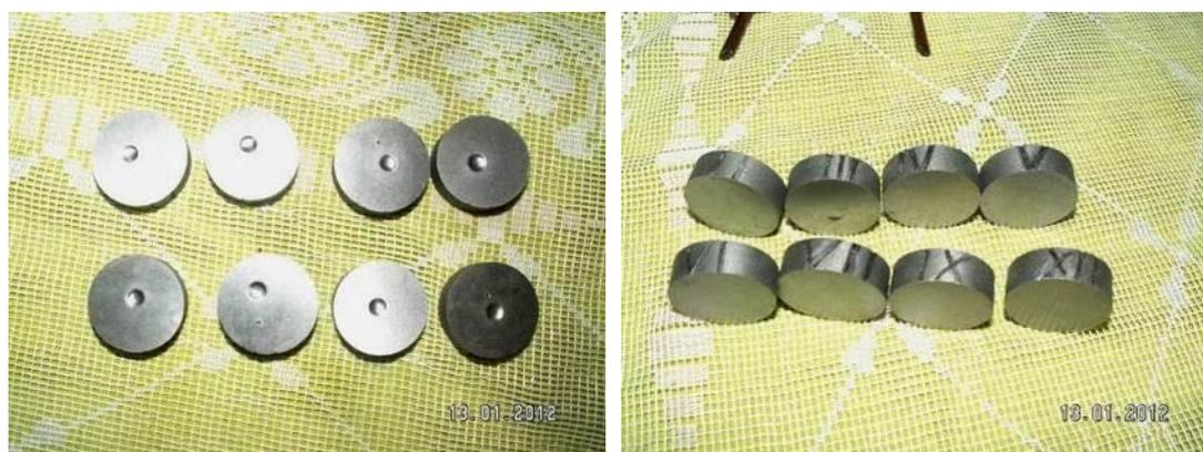
Рисунок 11. Внешний вид образцов для микроскопических исследований и твердости
